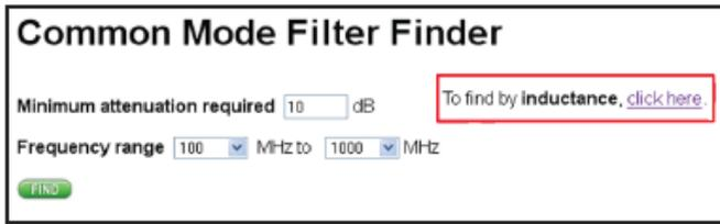
根据此信息，查找工具会搜索广泛的数据库并列出最佳的元件。然后用户可以选择最适用的扼流器。提供的数据包括相关规格，如额定电流、直流电阻和总尺寸。接下来显示的是规定频率范围内的共模和差模曲线，这就允许对这些项目进行快速和有目的性的比较。
